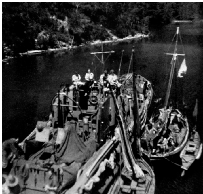
Ακταιωρός τύπου HDML και δίπλα της πλευρισμένα δύο καταδρομικά καϊκια: ένας βαρκαλάς με ιστιοφορία λατίني (πίσω) κι ένα τρεχαντήρι με απροσδιόριστη ιστιοφορία, πιθανώς μπούμας. Δεξιά διακρίνεται και ένα κανό (folboat), χαρακτηριστικό των SBS. Το αγκυροβόλιο είναι πιθανότατα το Port Deremen. (John Lodwick / The Filibusters)
